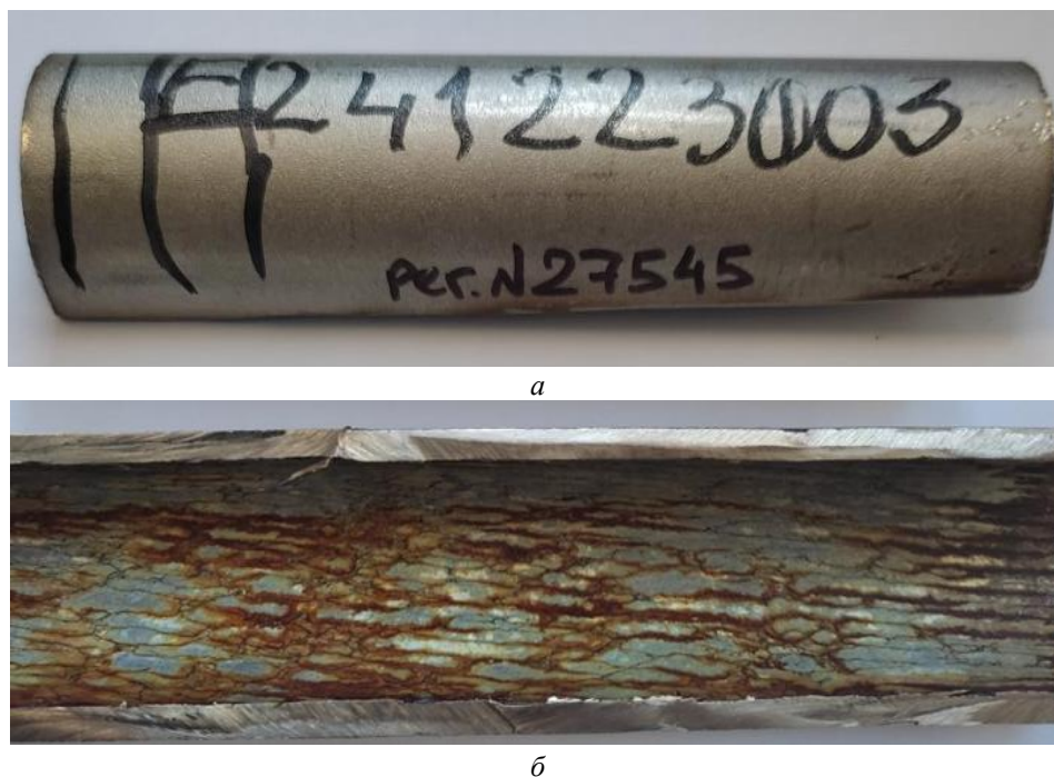
Рис. 4 Общий вид трубы с коррозионным повреждением: а – наружная поверхность; б – внутренняя поверхность
